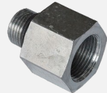
Переходник 107514 (Фитинг переходник Нар. /Внутр., G3/4"-G1/2", 400 бар) (РУБИН)
