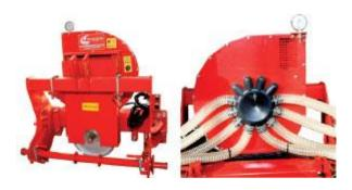
Привод вакуумного вентилятора - от BOM трактора с частотой 540 об/мин. Карданный вал снабжен обгонной муфтой, предохраняющей поликлиновый ремень привода вентилятора от повреждения при резком снижении оборотов двигателя трактора.
