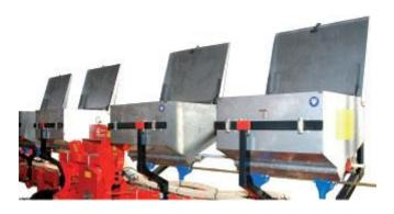
Дозатор выполнен из ударопрочного пластика, чрезвычайно уместного при работе в химически агрессивной среде, и обеспечивает точность внесения удобрений 1-2 кг на Га. Возможна установка минимальной нормы внесения удобрений от 30 кг/Га. Исключено просыпание удобрения при разворотах и транспортировке. Туковые ящики емкостью 600 л выполнены из нержавеющей стали.
