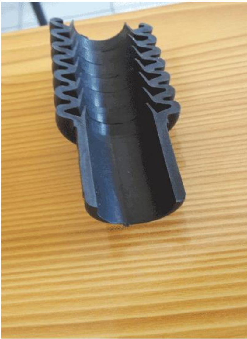
5. Семенной трубки которая регулируется в двух плоскостях, что позволяет , регулировать глубину заделки семян
